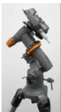
obr. 2-17 Istiaci gombíky nájdete nad delenými kruhmi jednotlivých osí
